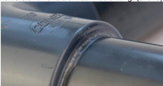
4. Halten Sie das Verbindungsrohr (Ventil zur Pumpe) an die Öffnung PUMP des 6-Wege-Ventils und richten Sie den Standort der Pumpe danach aus. (Der Kessel kann zur Hilfe gedreht werden) Merken Sie sich, welches Ende des Verbindungsrohres zum Ventil und welches zur Pumpe geht. Schrauben Sie die Übergangverschraubung in die Öffnung PUMP des Ventils.
