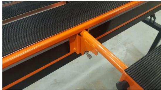
Um 90° drehen. Mit der Nivellierschraube justieren.
