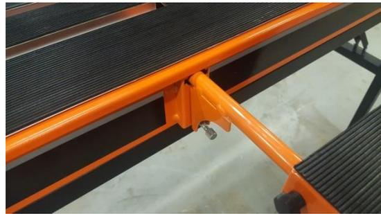
Um 90° drehen. Mit der Nivellierschraube justieren.
