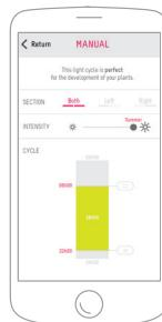
Ohne die App zu benutzen, können Sie unter den voreingestellten Modi "Sommer" und "Frühling" wählen, indem Sie die Taste ⊗ betätigen. Der Modus "Sommer" entspricht dabei einer hohen Lichtintensität (100 %) über 16 Stunden. Der Modus "Frühling" entspricht einer geringeren Lichtintensität (75 %) über 12 Stunden.
