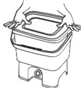
6. Fermer le récipient à compost à l'aide du couvercle fourni et vérifier que celui-ci est bien fermé hermétiquement. Le récipient doit rester fermé tout le temps. Il ne doit être ouvert que pour y ajouter les déchets.
