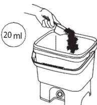
5. În cazul utilizării corespunzătoare a cuvei de compostare, se folosește zilnic 1 pahar de material auxiliar de compostare pentru deșeuri bio.
