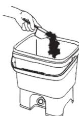
**1.** Bevor der Abfallkorb mit Abfällen gefüllt wird, wird mit dem eingeschlossenen Messbecher 1 Dose Kompostierhilfe für Bioabfälle über das Sieb zerstreut.
