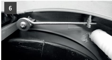
4. Vissez le support du tuyau à l'aide d'un tournevis cruciforme. Retirez le dispositif de sécurité (pince en plastique sur le raccord du tuyau) et tirez sur le tuyau avec le raccord rapide.
