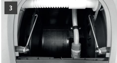
1. Enlever le clapet sur le haut de l'enrouleur de tuyau.
