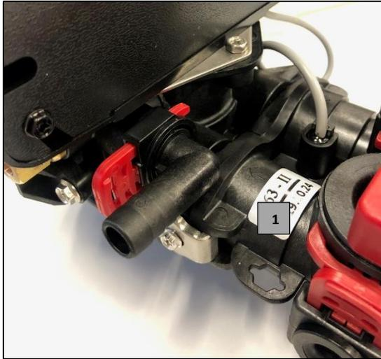
1. Markierung der Fließrichtung für den Wasserein- und Ausgang
