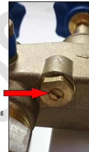
Durch Drehen der Stellschraube ändern Sie die Verschneidung mit Rohwasser.
