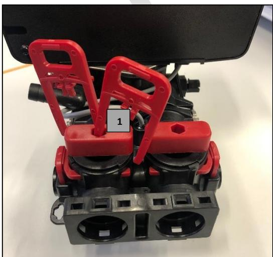
1. Zum Einsetzen der Gewindestücke die Sicherungsclips nach oben aus dem Anschlussstück ziehen
