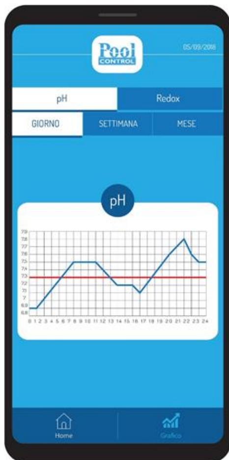
Alle 30 Minuten wird der aktuelle Messpunkt der Pumpe gespeichert. Diese Messpunkte kann man sich in einer 24-Stunden-, 7-Tage- und 30-Tage-Historie anzeigen lassen.
