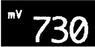
Während des Betriebs ist der aktuelle Rx-Wert auf dem Display sichtbar. Der Betrieb der Pumpe ist proportional, mit Pause/Arbeitszeit. Der maximale Proportionalitätswert wird werkseitig auf einen Wert von 100 mV eingestellt.
