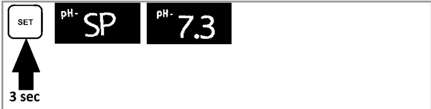
Halten Sie SET für 3 Sekunden gedrückt, bis SP und anschließend der zuletzt eingestellte Sollwert angezeigt wird. Drücken Sie unner wueder kurz auf SET bis der gewünschte Sollwert angezeigt wird. (zwischen 6,0 und 8,0) Nachdem der gewünschte Wert angezeigt wird warten Sie 5 Sekunden ohne eine Taste zu drücken und die Pumpe speichert automatisch den Sollwert.
