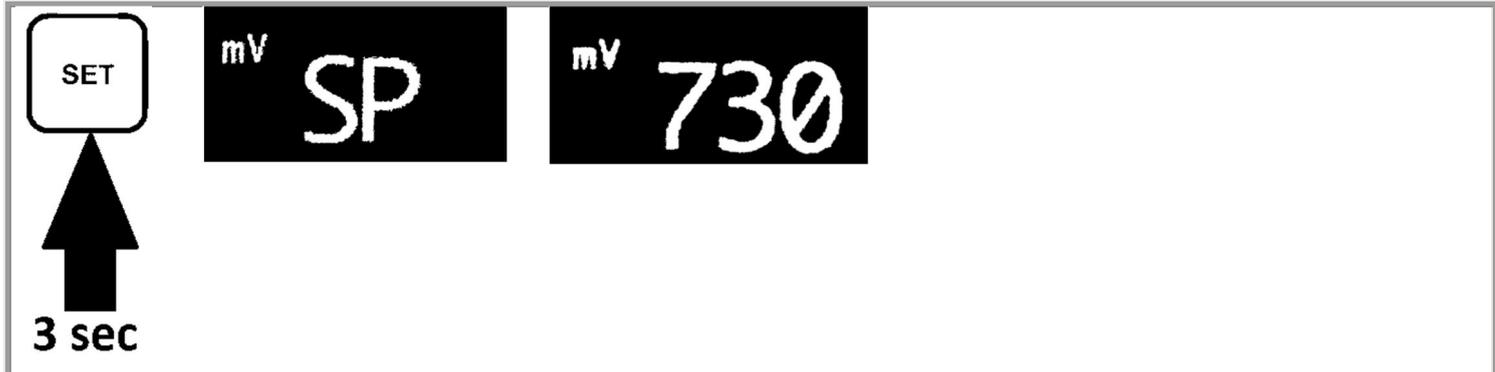
Halten Sie SET für 3 Sekunden gedrückt, bis SP und anschließend der zuletzt eingestellte Sollwert angezeigt wird. Drücken Sie unner wueder kurz auf SET bis der gewünschte Sollwert angezeigt wird. (zwischen 300 und 800 mV) Nachdem der gewünschte Wert angezeigt wird warten Sie 5 Sekunden ohne eine Taste zu drücken und die Pumpe speichert automatisch den Sollwert.
