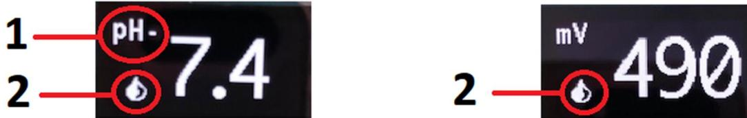
Das Abbild zeigt die Anzeige einer Pumpe im pH- und Rx-Modus.
