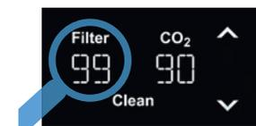
Показатель остаточной пропускной способности фильтра сбрасывается, и на экране снова отображается 99%. Система очищена и готова к эксплуатации.
