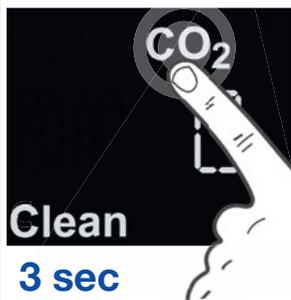
Confermare la sostituzione premendo "CO<sub>2</sub>" per 3 secondi.
