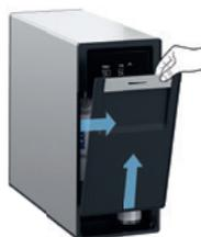
**Open de klep. Verwijder de oude filter.** U kunt dit doen door de filter in het apparaat naar voren te trekken.
