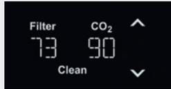
Geeft de normale bedieningsmodus met resterende capaciteit voor CO<sub>2</sub> en Filter weer (in %). Het cijfer links toont de resterende capaciteit voor de filter. Het cijfer rechts toont de resterende capaciteit voor de CO<sub>2</sub>-cilinder.
