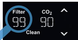
Pozostała wydajność filtra zostanie zresetowana i znowu będzie widoczna wartość 99%. System jest czysty i ponownie gotowy do pracy.
