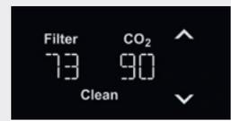
Modo de funcionamiento normal con indicación sobre la capacidad de CO<sub>2</sub> y de filtración restante (en %). La cifra de la izquierda indica la capacidad restante del filtro. La cifra de la derecha indica la capacidad restante de CO<sub>2</sub> de la bombona.
