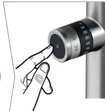
Toque el sensor lateral para activar la cantidad de agua seleccionada y el tipo de agua mineral.
