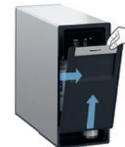
Откройте клапан. Снимите старый фильтр. Для этого в устройстве можно перевернуть фильтр вперед.
