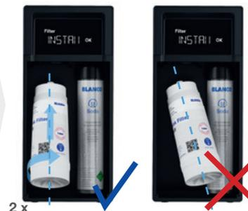
Schroef de filter erin door ongeveer twee keer te draaien. Zorg ervoor dat de nieuwe filter recht wordt geplaatst, niet schuin! Voor het in- en uitschroeven kunt u de filter in het apparaat naar voren kantelen.
