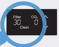
Por favor, compruebe la pantalla: es necesario cambiar el bombona de CO<sub>2</sub> (0 %) (pág. 220) o limpiar y cambiar el filtro (10 %) será necesario dentro de poco tiempo.
