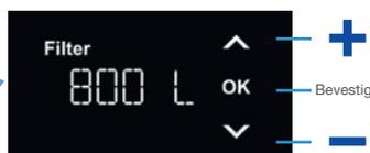
Lees de filtercapaciteit af in de filterdocumenten. Voer het cijfer handmatig in. Bevestig door op "OK" te drukken.
