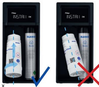
Vissez le filtre en effectuant environ deux tours. Lorsque vous insérez le nouveau filtre, veillez à ce qu'il soit placé droit et non pas incliné ! Vous pouvez incliner le filtre vers l'avant dans l'appareil afin de le visser et de le dévisser.
