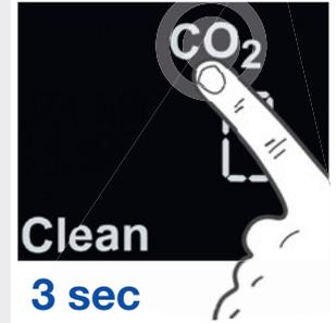
Bevestig de vervanging door drie seconden lang op "CO<sub>2</sub>" te drukken.
