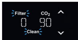
Cuando el filtro se ha agotado o es hora de realizar una limpieza, los símbolos "Clean" y "Filter" parpadearán. El sistema necesita limpiarse y que se instale un filtro nuevo.
