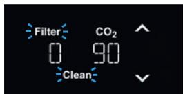
Jeśli filtr się zużył lub nadszedł czas na czyszczenie, zaświecą się symbole „czyszczenie” i „filtr”. Należy wyczyścić system i zainstalować nowy filtr.
