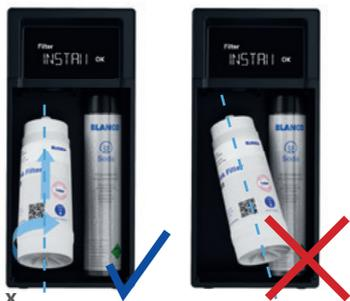
大约拧两圈拧入过滤器。插入新过滤器时, 确保将其垂直放置, 不要倾斜! 您可以在设备中向前倾斜过滤器, 以方便拧入和拧出。
