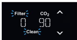
Wanneer de looptijd van de filter ten einde is of het tijd is om te reinigen, dan knippen de symbolen "Clean" en "Filter". Het systeem moet worden gereinigd en een nieuwe filter moet worden geïnstalleerd.
