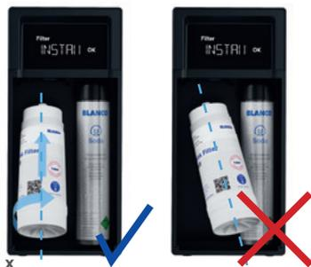
Avvitare fermamente il filtro in circa due giri. Quando si inserisce un nuovo filtro, assicurarsi che sia dritto, non inclinato! Inclinare il filtro in avanti nell'apparecchio per avvitarlo e svitarlo.
