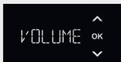
Houd de OK-knop 3 seconden ingedrukt om de kalibratie te starten. De kalibratie start vervolgens automatisch en u kunt de af te geven hoeveelheid opnieuw instellen (zie p. 109). De draaiknop op de mengkraan mag niet op '0' worden gezet bij het starten van het kalibratieproces.
