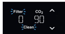
Quando il filtro si esaurisce o è giunto il momento di effettuare la pulizia, i simboli "Pulizia (Clean)" e "Filtro (Filter)" lampeggiano. Il sistema deve essere pulito e occorre installare un nuovo filtro.
