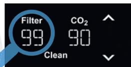
De resterende filtercapaciteit is gereset en geeft 99 % aan. Het systeem is gereinigd en kan opnieuw worden gebruikt.
