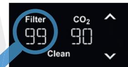
La capacité restante du filtre est réinitialisée et indique à nouveau 99 %. Le système est nettoyé et prêt à fonctionner à nouveau.
