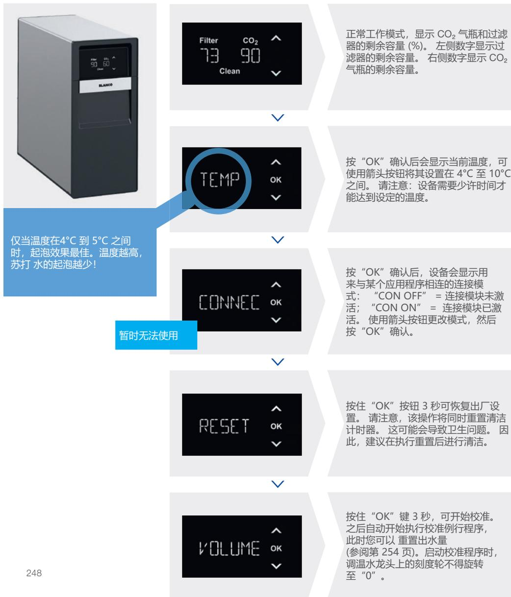
正常工作模式，显示 CO<sub>2</sub> 气瓶和过滤器的剩余容量 (%)。左侧数字显示过滤器的剩余容量。右侧数字显示 CO<sub>2</sub> 气瓶的剩余容量。
