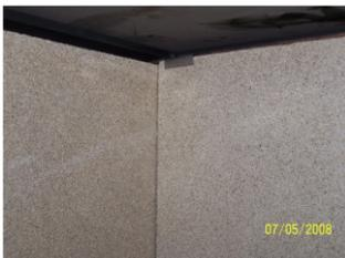
Bei Bedarf: Erst obere Vermiculite unten links und rechts, dann untere Vermiculite unten links und rechts herausnehmen.
