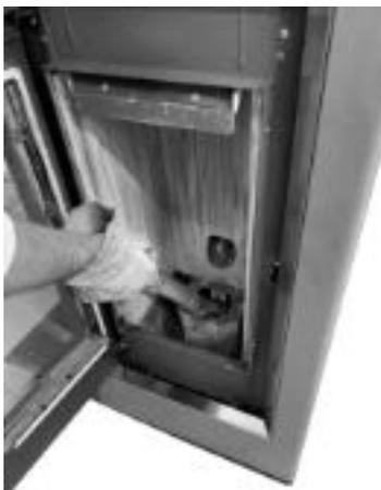
*Fig. 35 - Reinigung Fach Brennschale*
