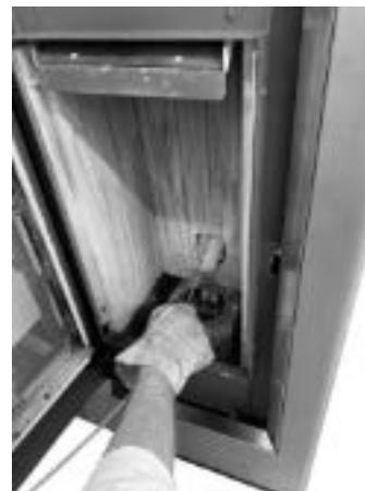
*Fig. 36 - Reinigung mit Flaschenbürste*
