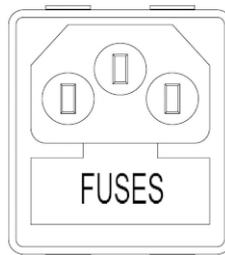
Fig. 38 - Abdeckklappe mit Sicherungen, die ausgewechselt werden müssen
