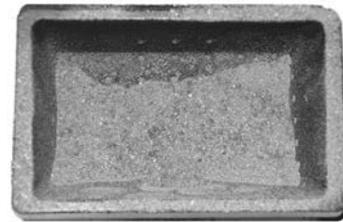
*Fig. 32 - Beispiel für eine schmutzige Brennschale*
