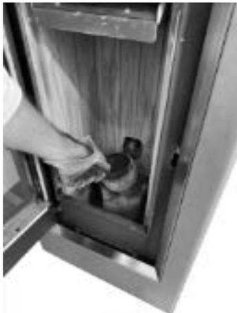
*Fig. 33 - Brennschale entnehmen*
