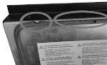
Fig. 27 - Verschlechterte Dichtung
