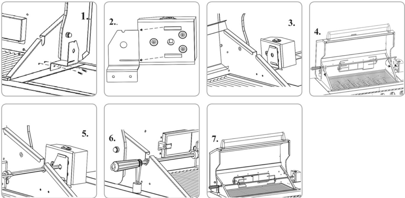
1. Befestigen Sie die Halterung an der rechten Seite des Grills wie in Abb. 1, indem Sie die zwei Schrauben durch die Halterung und die Außenseite des Grills stecken. Sichern Sie die Schrauben mit den Muttern. Achten Sie darauf, die Schrauben nicht zu fest anzuziehen.
