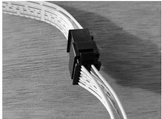
(1) Die Stecker der Heizkabel einstecken, (2) Den Stecker der Steuerkabel einstecken.
