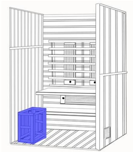
(7) Montieren Sie die Ofengitter (mit Schrauben M3,5\*40)
