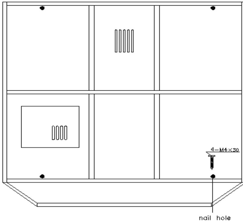
Montieren Sie die Staubschutzhaube mit Schrauben auf dem Dach
