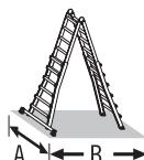
Rozměry rozložených schůdků (maximálně vysunuté výsuvné prvky)
