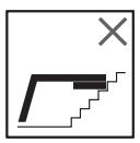
Arbeitsplattform nicht im teilweise ausgeklappten Zustand verwenden.
