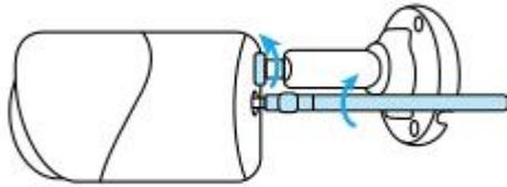
*Schritt 3. Lösen Sie den Einstellknopf und richten Sie die Kamera in die richtige Richtung aus.*
