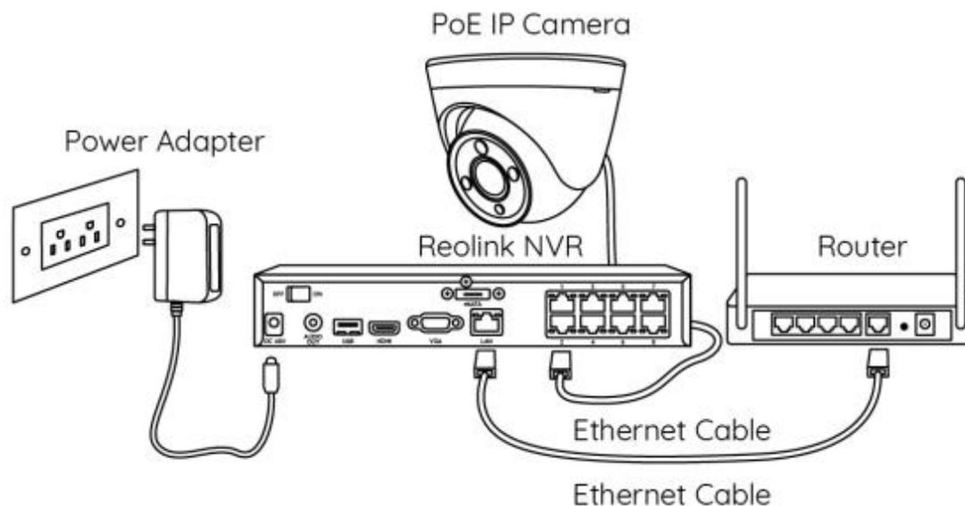
**HINWEIS:** Sie können die Kamera mit einem PoE-Switch, einem PoE-Injektor, einem Reolink PoE NVR oder einem DC-12V-Netzadapter (nicht im Lieferumfang
