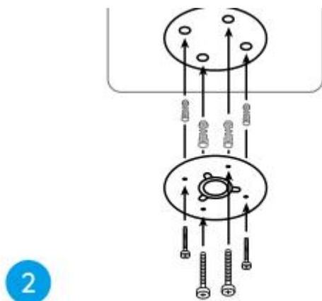
**Hinweis:** Verwenden Sie bei Bedarf die in der Packung enthaltenen Dübel für den Trockenbau.
