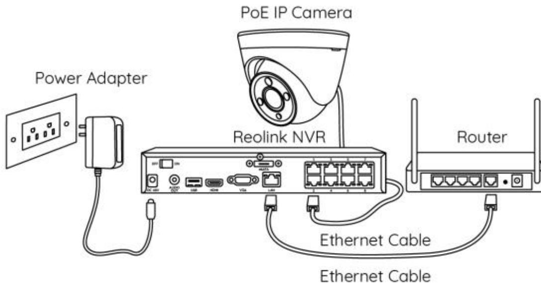
**HINWEIS:** Sie können die Kamera mit einem PoE-Switch, einem PoE-Injektor, einem Reolink PoE NVR oder einem DC-12V-Netzadapter (nicht im Lieferumfang enthalten) mit Strom versorgen.
