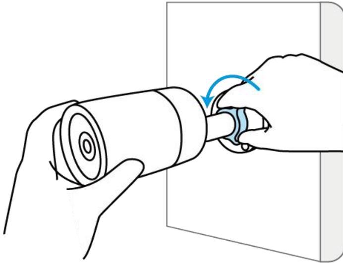
**Schritt 4.** Drehen Sie zuletzt den Drehknopf im Uhrzeigersinn, um die Kamera zu befestigen.
