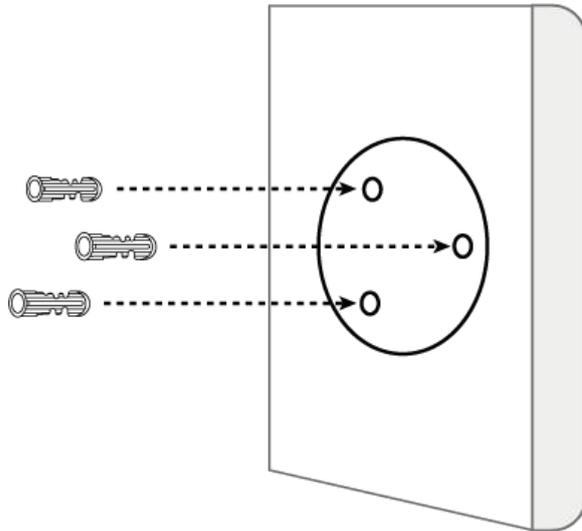
**Schritt 2.** Montieren Sie die Halterung mit den mitgelieferten Schrauben.
