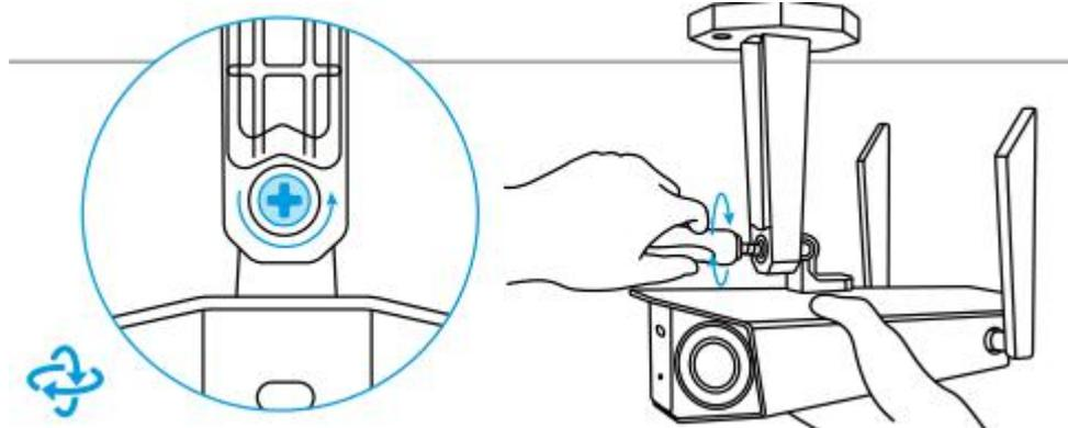
**Schritt 3.** Befestigen Sie die Kamera.
