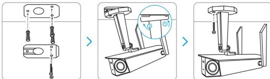
**Schritt 2.** Passen Sie den Blickwinkel der Kamera an.
