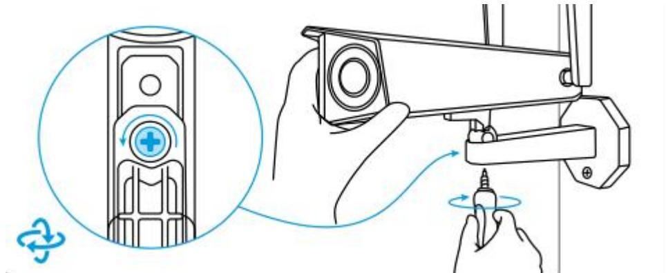
**Schritt 3.** Befestigen Sie die Kamera.
