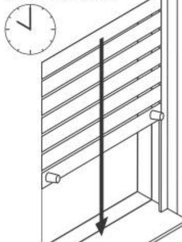
Um eine automatische Schließzeit einzustellen, drücken Sie zur gewünschten Uhrzeit die Ab-taste und die Uhr-Taste zusammen für ca. 2 Sekunden, der Rollladen setzt sich nun in Bewegung und speichert die aktuelle Zeit ein. Diese Einstellung muss zur gewünschten Zeit vorgenommen werden, z.B. 22 Uhr abends!
