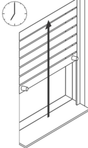
Um eine automatische Öffnungszeit einzustellen, drücken Sie zur gewünschten Uhrzeit die Auf-taste und die Uhr-Taste zusammen für ca. 2 Sekunden, der Rollladen setzt sich nun in Bewegung und speichert die aktuelle Zeit ein. Diese Einstellung muss zur gewünschten Zeit vorgenommen werden, z.B. 7 Uhr morgens!
