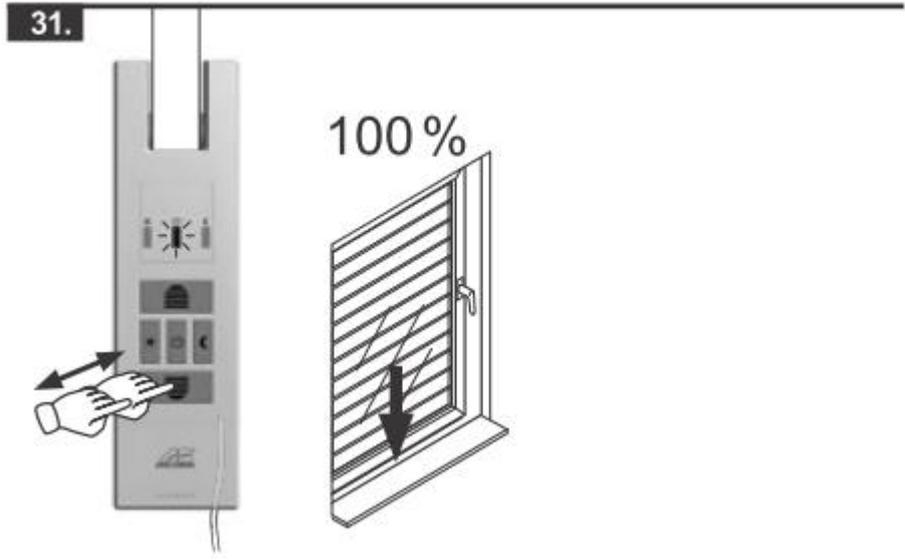
Tippen Sie die Abtaste solange nach, bis der Rollladen in der gewünschten Endposition ist.
