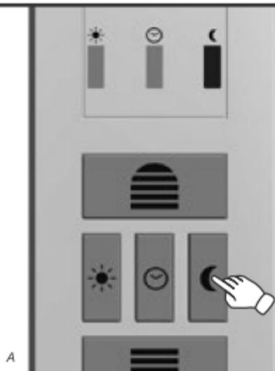
Durch drücken der Taste Dämmerung wird die Dämmerungsfunktion ein- oder ausgeschaltet:
