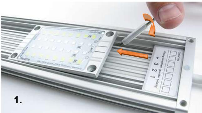
**Anheben und Entnehmen des Moduls in zwei Schritten: Den kurzen, gummierten Schenkel des Spezial-Schlüssels in die Gewindenuten einführen und das Modul "heraushebeln"**
