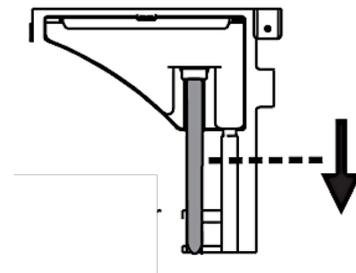
2. Platzieren Sie das offene Schlauchende in einem Abfluss etc.
