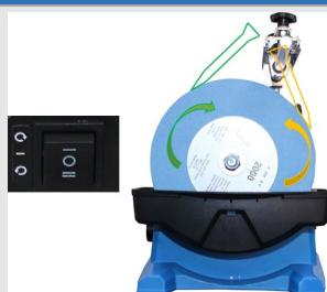
**Wählen sie die passende Drehrichtung in Abhängigkeit von der Werkzugposition**
