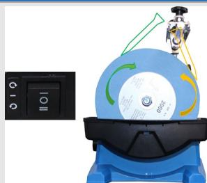
**Selezionare il senso di rotazione appropriato a seconda della posizione dell'utensile**
