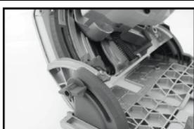
Stellen Sie mit einem Winkel das Sägeblatt genau 45° im Verhältnis zur Grundplatte ein. Lösen Sie die Anzeige für den vertikalen Gehrungswinkel und ziehen Sie diese bei genau 45° an der Skala fest.
