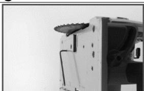
Utilisez une équerre pour contrôler que l'angle entre le socle et la lame de scie soit précisément de 90°. Si besoin, réglez l'angle à l'aide des deux vis situées en dessous du socle.
