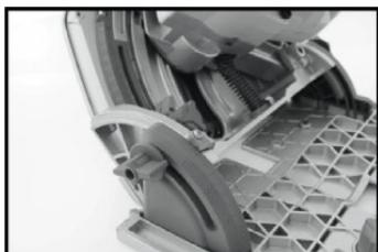
Nastavte pomocí úhelníku pilový kotouč přesně do úhlu 45° vůči základní desce. Povolte páčku pro vertikální úhel úkosu a zaaretuje ji přesně na škále v úhlu 45°.
