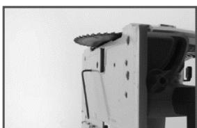
Benutzen Sie einen Winkel zur Kontrolle, ob der Winkel zwischen dem der Grundplatte und dem Sägeblatt genau 90° beträgt. Sollte dies erforderlich sein, stellen Sie den Winkel mithilfe der beiden Schrauben unter der Grundplatte ein.
