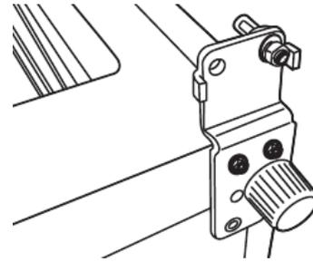
6. Versetzen Sie den Scharnierstift (1) an Position 2. Bringen Sie das Scharnier auf der gegenüberliegenden Seite an. Schrauben Sie den Fuß ein.
