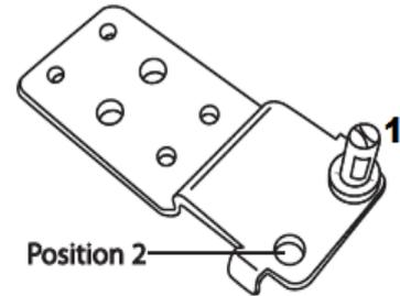
7. Bringen Sie die Befestigungsplatte mit drei Schrauben auf der gegenüberliegenden Seite an. Schrauben Sie den Fuß ein.
