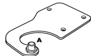
4. Entfernen Sie die Scharnieraufnahme unten an der Tür und bringen Sie diese an der gegenüberliegenden Seite an.
