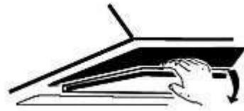
3. Stecken Sie den Kohlefilter auf das Gerät und drehen Sie ihn im Uhrzeigersinn. Wiederholen Sie den Vorgang auf der anderen Seite.
