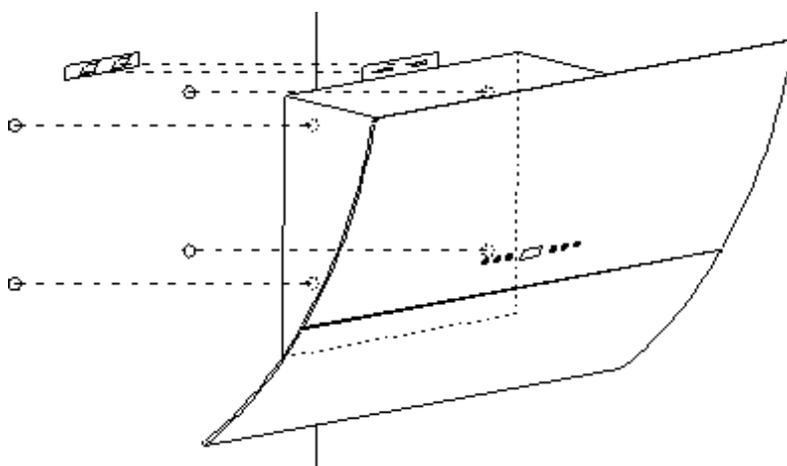
3. Hängen Sie die Haube auf die Befestigungsklammer. Befestigen Sie die Haube (siehe auch Schritt 2). Die Haube muss waagrecht ausgerichtet sein. Kontrollieren Sie die Ausrichtung mit einer Wasserwaage.
