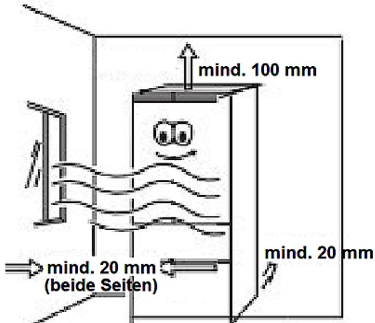
**RAUMBEDARF DES GERÄTES INKL. DER MINDESTABSTÄNDE FÜR EINE ORDNUNGSGEMÄßE BELÜFTUNG BEI GESCHLOSSENER TÜR**
