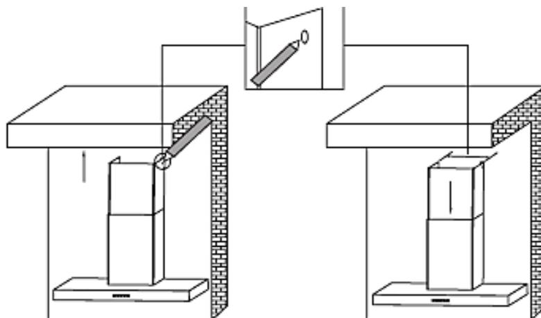
10. Bohren Sie für den Haltebügel zwei  $\text{\O} 8 \text{ mm}$  Löcher in der entsprechenden Höhe. Befestigen Sie den Haltebügel an der entsprechenden Stelle an der Wand (s. Abb. unten).
