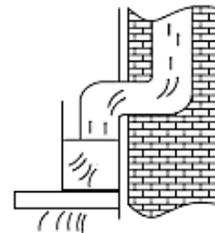
**Horizontal:** Der Abluftschlauch wird zu einer Auslassöffnung mit Gitter\* in der Hauswand geführt.
