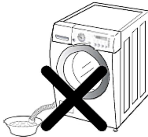
➤ Das Schlauchauslass des Wasserablaufschlauchs **darf nicht** in Wasser eingetaucht sein.
