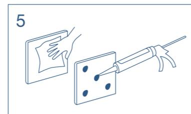
**5. Oczyszcz wilgotną szmatką tył panelu z pyłku. Następnie nałóż klej na panel w pięciu miejscach.**
