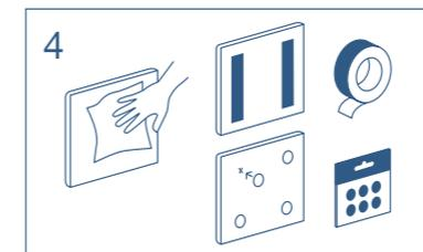
**4. Oczyszcz wilgotną szmatką tył panelu z pyłku. Następnie przyklej taśmę lub rzepy na panel białą stroną.**
