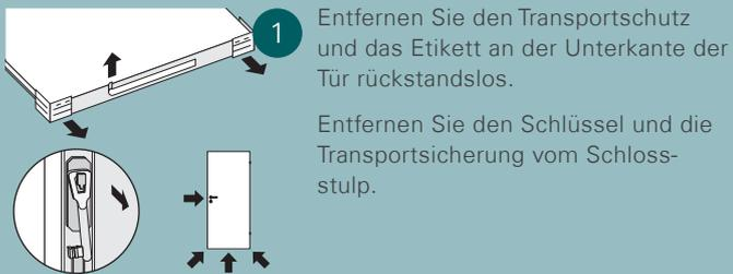
1 Entfernen Sie den Transportschutz und das Etikett an der Unterkante der Tür rückstandslos.
