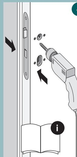
4 Bohren Sie jetzt die Löcher zur Montage des Türbeschlags gemäß der Anleitung Ihres Beschlagherstellers. Im Schlosskasten sind entsprechende Durchgangsbohrungen vorgesehen.
