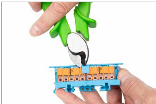
Nur notwendig bei Brücker mit Verriegelungsfunktion Entfernen der Verriegelung zum Zweck der bewussten Entnahme des Brückers
