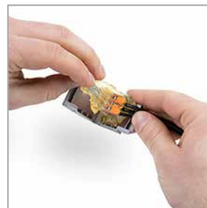
Stromkreise einfach erweitern: Gelbox öffnen, das Gel aus der Klemme entfernen, die Klemme öffnen und die neuen Komponenten an das Kabel anschließen.
