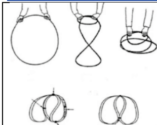
Corretto arrotolamento delle lame per seghe a nastro
