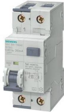
FI/LS-Schalter, 10 kA, 1P+N, Typ A, kurzzeitverzögert G, 30 mA, superresistent K, B-Char, In: 13 A, Un AC: 230 V
