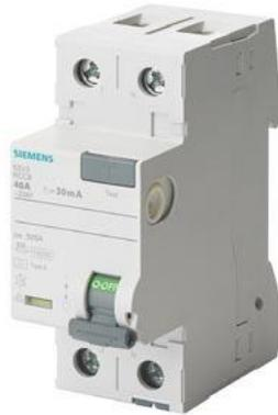
FI-Schutzschalter, 2-polig, Typ A, In: 40 A, 30 mA, Un AC: 230 V, mit thermischem Überlastschutz
