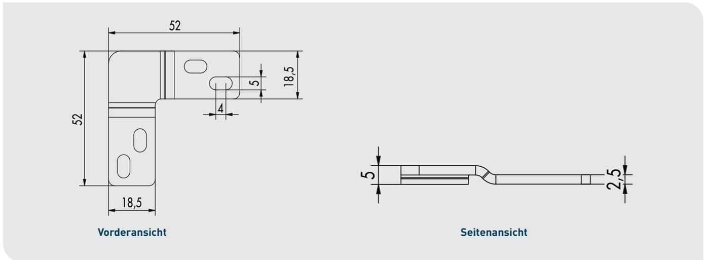
**HS Terra System Außenwinkel**
