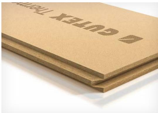
Gutex Thermowall-gf ist die besonders druckfeste, stabile verputzbare Dämmplatte in 40 oder 60 mm Dicke – ideal für die direkte Beplanung auf Holzständern im ökologischen Thermowall WDVS.
