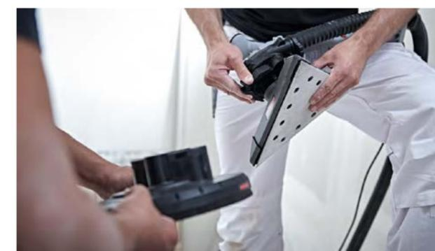
Der Wechselkopf vereinfacht das Schleifen von Ecken und Kanten.
