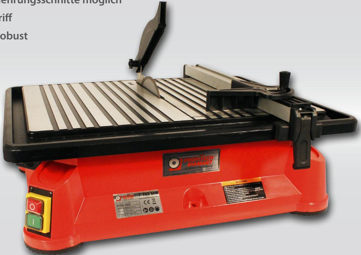
Die leichte und kompakte Fliesenschneidmaschine TC 180 ist ideal für jede Baustelle. Das Gehäuse aus stabilem Kunststoff ist einfach zu reinigen und enthält eine Wanne für Kühlwasser. Gerungsschnitte von 22,5° und 45° sind ebenso möglich wie ein einfacher Transport dank Transportgriff. Arbeitsfläche in Aluminiumguss, Größe 508x380 mm
