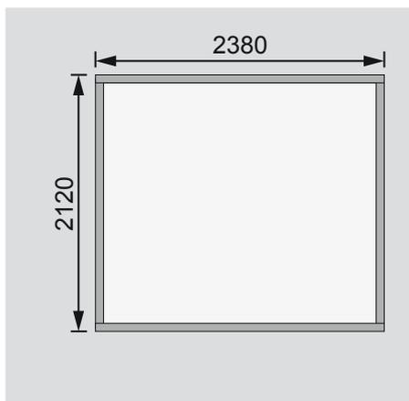
**Fundamentplan mit Boden (in mm)**
