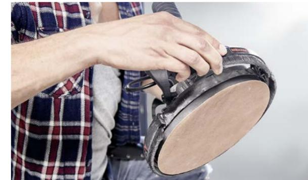
Abnehmbare Schleifkopfspitze für randnahes Schleifen.
