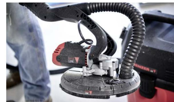
Flexibler Schleifkopf für optimale Anpassung an Wänden.
