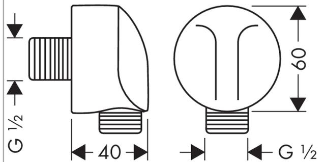
**Fixfit E Schlauchanschluss ohne Rückflussverhinderer**
