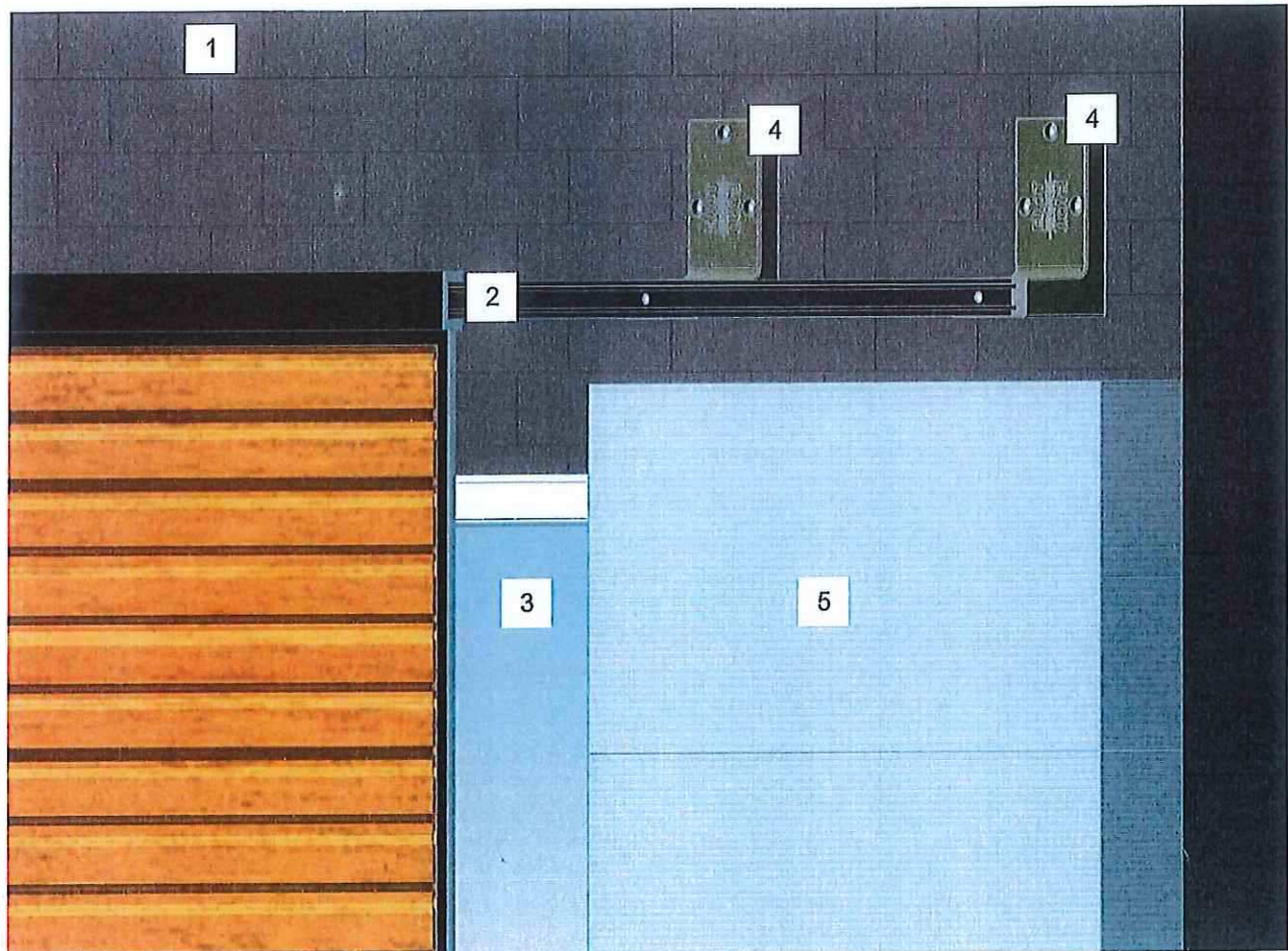
Darstellung 1: Beispiel Einbauzustand Schiebeladen – stirnseitige Montage
