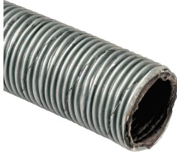
**Flexibles Stahlrohr aus Bandstahl (Zinkschicht 3 - 4 Mikrometer) mit innenliegender Isolationsschicht geeignet für Photovoltaik-, Industrie-, Maschinen- und Anlageninstallationen**
